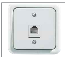
Telefonska utičnica Telefonska utičnica Cat. 3 sa džekom RJ-12, 6-pinska za priključak običnih i ISDN linija sa kontaktima na utiskivanje u viljuške.
