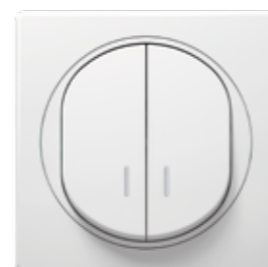
E626.00 Sklopka serijska sa indikacijom 10AX/250V~ Serial switch with indication 10AX/250V~ • Indikacija svetli kada je sklopka isključena • Indication turns on when the switch is off
