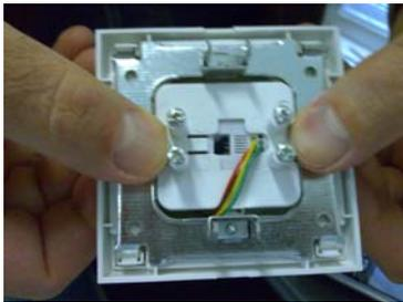
Blagim pritiskom i potiskivanjem palčevima na žabice koje drže nosač priključnice za metalni okvir, oslobodite nosač modularnog konektora sa metalnog okvira.
