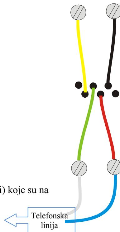
Postavite viljuškice spoljnih provodnika (u ovom slučaju žuti i crni) koje su na krajevima žica ispod vijaka i pogodnim odvijačem ih pritegnite.
