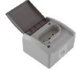
Trofazna priklju nica IEC 60884-1, CEE7 16A/440V; IP 44
