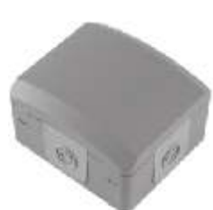
Razvodna kutija sa 4 uvoda IEC 60670; CEI EN 60529; IP 44
