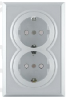
Dvostruka priklju nica sa sa zaštitnim elementom IEC 60884-1, CEE7 16A/250V; IP 20
