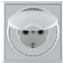
Dvopolna priklju nica sa poklopcem IEC 60884-1, CEE7 16A/250V; IP 20
