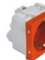
2M Dvopolna priklju nica sa zaštitom (narandžasta) 16A/250V sa kontaktom za uzemljenje
