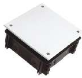
Razvodna kutija 100x100mm Izrađena od termoplasta IEC 60670; CEI EN 60529 Ugradnja u zid; IP 40
