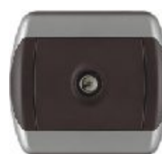
TV priključna nica sa jednim modulom (crno / srebrna) IEC 169-2; CEI EN 50083-1, -2, -4; Priključak: antenski konektor IP 20
