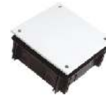
Kutija za izjednačavanje potencijala Izrađena od termoplasta (za priključivanje 6 provodnika preseka do 6mm 2 i jednog do 16mm 2 ) IEC 60670; Ugradnja u zid; IP 40
