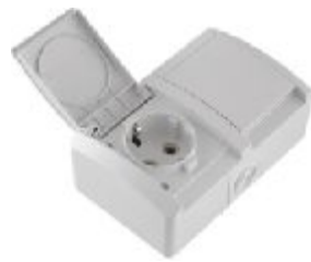
Dvostruka horizontalna priklju nica IEC 60884-1, CEE7 16A/250V; IP 44
