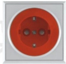
Dvopolna priklju nica sa zaštitnim elementom, narandžasta IEC 60884-1, CEE7 16A/250V; IP 20
