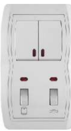
Vertikalna sklopka za kupatilo sa serijskom sklopkom i signalnim sijalicama IEC 60669-1; IP 20 Sklopke: 10AX/250V Pregibne sklopke: 16AX/250V
