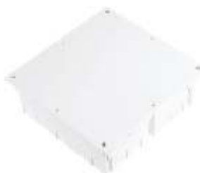
Razvodna kutija 228x240mm Izrađena od termoplasta IEC 60670 Ugradnja u zid; IP 40
