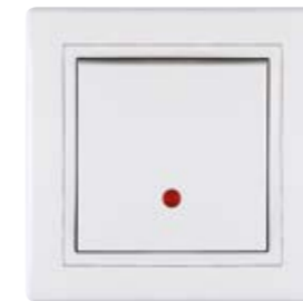
625.xxx Sklopka jednapolna sa indikacijom 10AX/250V~ Single-pole switch with indication 10AX/250V~ • Indikacija svetli kada je sklopka isključena • Indication turns on when the switch is off
