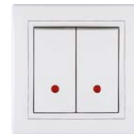
626.xxx Sklopka serijska sa indikacijom 10AX/250V~ Serial switch with indication 10AX/250V~ • Indikacija svetli kada je sklopka isključena • Indication turns on when the switch is off
