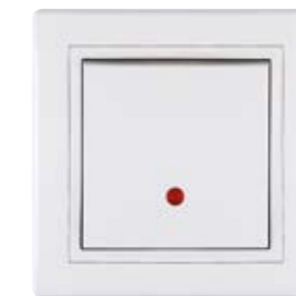
619.xxx Sklopka jednapolna sa indikacijom 16AX/250V~ Single-pole switch with indication 16AX/250V~ • Indikacija svetli kada je sklopka isključena • Indication turns on when the switch is off
